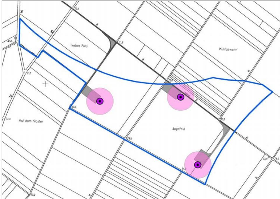
**Abb. 2: Konzentrationszone (blau) mit WEA-Standorten (Fundamente und Rotordurchmesser, pink), Kranstellflächen und Erschließung (grau)**
