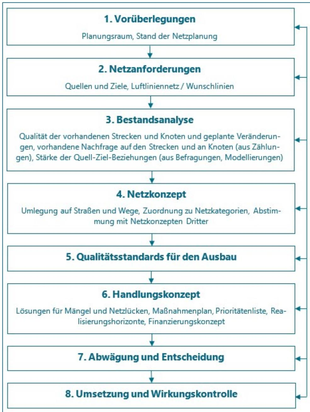
**Bild 2:** Schematische Darstellung einer Netzkonzeption für den Radverkehr (Quelle: eigene Darstellung; Grundlage: FGSV, 2010, ERA)
