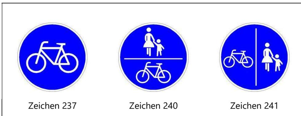
**Bild 3:** Zeichen für die Benutzungspflicht von Radverkehrsanlagen (Quelle: Anlage 2 (zu § 41 Abs. 1) StVO)
