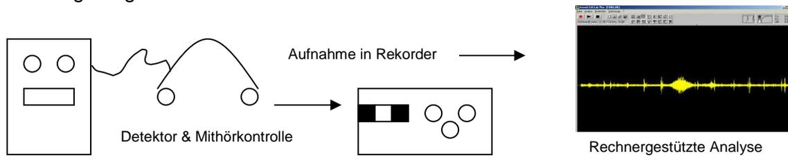
**Abb. 5:** Arbeitsprinzip mit TR30 (Zeitdehnungsdetektor), Kopfhörer (Echtzeit-Mithörkontrolle), Rekorder und Analyse-Software.
