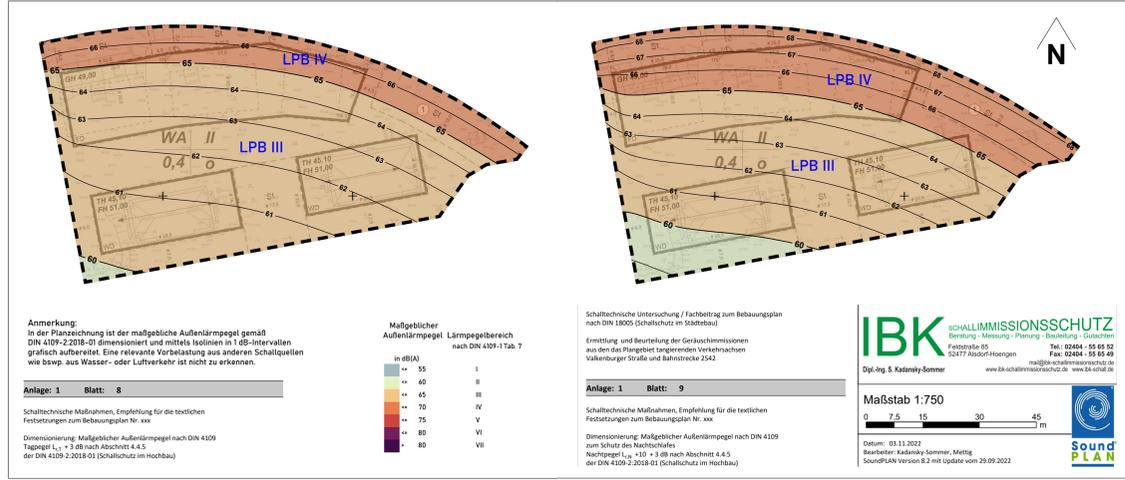
**Anmerkung:** In der Planzeichnung ist der maßgebliche Außenlärmpegel gemäß DIN 4109-2:2018-01 dimensioniert und mittels Isolinien in 1 dB-Intervallen grafisch aufgetragen. Eine relevante Vorbelastung aus anderen Schallquellen wie bspw. aus Wasser- oder Luftverkehr ist nicht zu erkennen.
